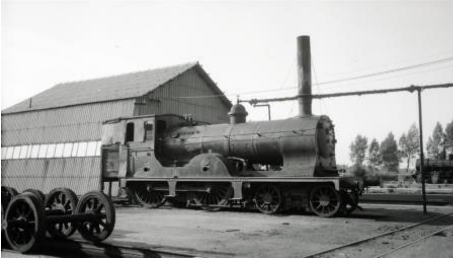
Locomotive à vapeur sans tender A511/323 à Hasselt, utilisée comme générateur fixe de vapeur dans la remise de Hasselt. (Ref. Q0175)
